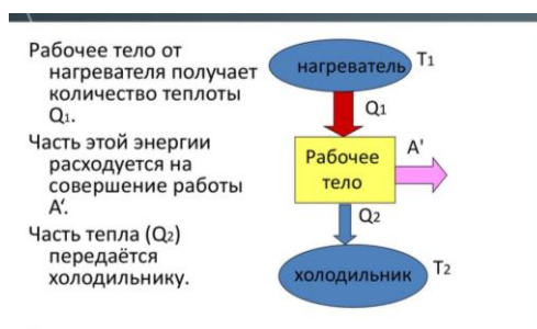
Рисунок 4. Принцип действия двигателя
