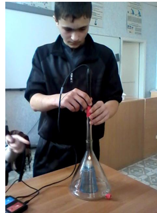
Рис. 1. Опыт по изучению изменения содержания кислорода в воздухе при горении свечи в закрытом сосуде.
